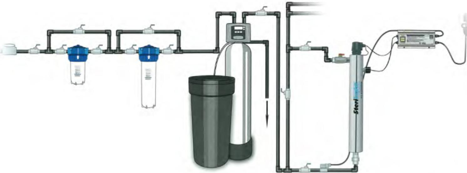
Schéma – installation type au point d'entrée
